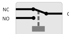
Configuración del relé (sin corriente)
