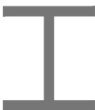
Viga de acero
