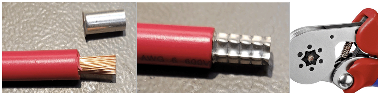
Puntera con crimpado hexagonal
