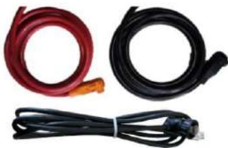
Modelo: RW-M6.1-B-PCable1500 Detalles: Un par de cables de alimentación de CC de 2/0 AWG (un extremo tiene un terminal a prueba de agua, el otro extremo es un terminal de cobre M10) y un cable de comunicación RJ45 se conectan con un inversor híbrido (un extremo tiene un terminal a prueba de agua). La longitud predeterminada es de 1500 mm.
