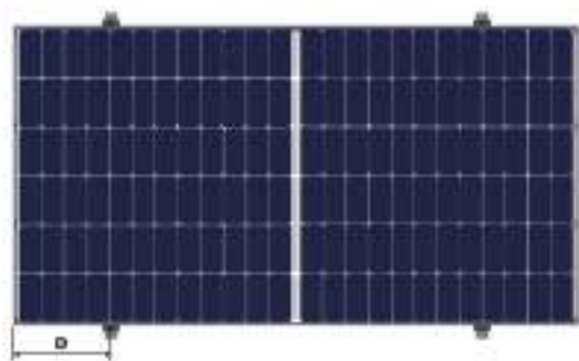
Instalación de módulo enmarcado con accesorios de fijación en lados largos. (haz perpendicular a los lados largos)(longitud de la abrazadera \geq 40 mm)
