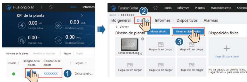
Figura 7-6 Diseño físico de los módulos fotovoltaicos
