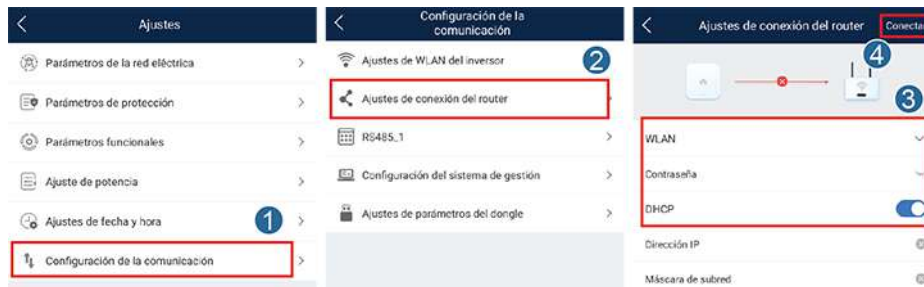
Figura C-2 Configuración de los parámetros del router
