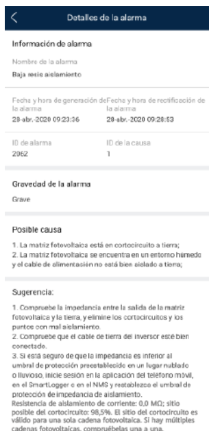
Figura G-1 Detalles de alarma
